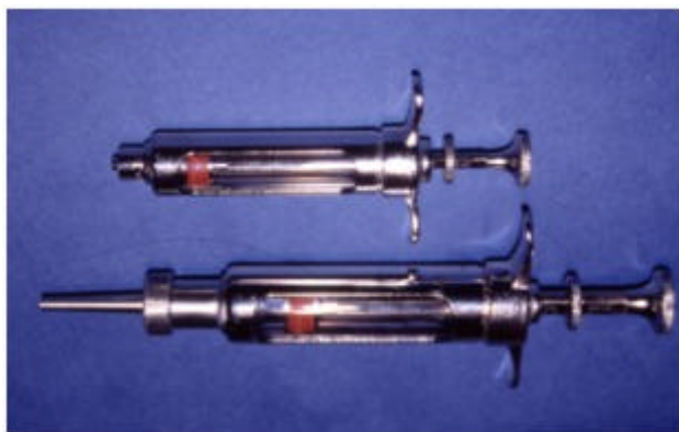
Fig. 1: Siringhe in acciaio inox e vetro graduate, regolabili, utilizzate dall'autore per l'alimentazione forzata di animali di medie e grandi dimensioni. Le siringhe sono smontabili e autoclavabili (sterilizzabili) in ogni singolo componente; è possibile regolare la pressione esercitata durante la somministrazione di cibo liquido e semiliquido, grazie alla regolazione del cilindro in silicone. L'utilizzo di tali siringhe è preferibile a quello di siringhe in plastica, oltretutto per possibilità di regolare la pressione esercitata durante la manualità, anche per il maggiore diametro del foro d'uscita del "becco", e per l'adattabilità a sonde di gomma o silicone di diverso diametro (foto del Dr. Matteo Rossi ).
